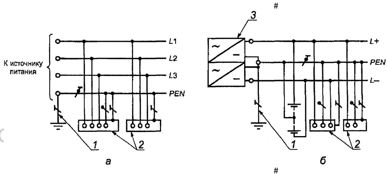
1 - заземлитель нейтрали (средней точки) источника питания; 2 - открытые проводящие части; 3 - источник питания постоянного тока
