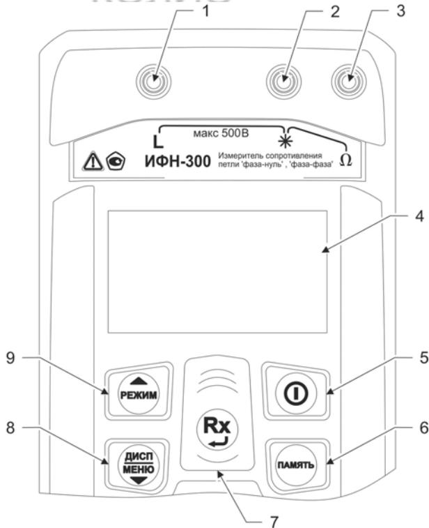
Рисунок 1.4.2 - Расположение разъёмов подключения и органов управления ИФН-300
