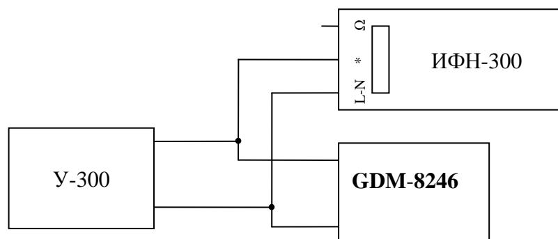
Рисунок 6.7.1 – Схема проверки погрешности при измерении напряжения
