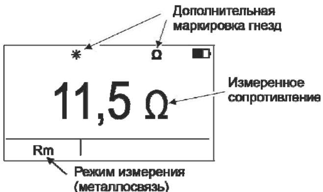
Рисунок 2.4.3.2 - Измерения сопротивления металлосвязи
