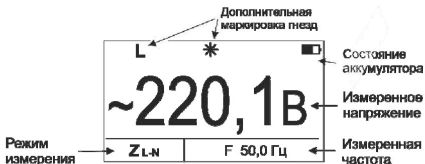
Рисунок 2.4.1 - Измерение напряжения и частоты
