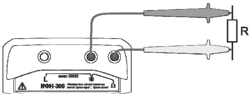
Рисунок 2.4.3.1 - Измерение сопротивления металлосвязи
