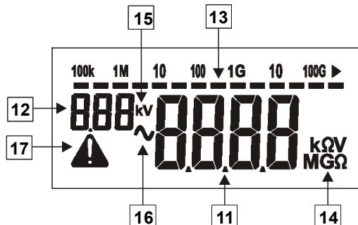
Рис.2. Жидкокристаллический дисплей измерителя MIC-3
