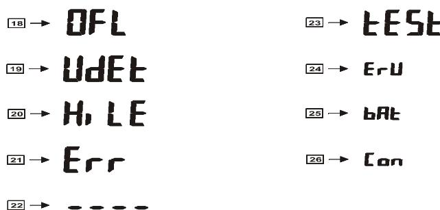
Рис.3. Надписи и символы, отображённые измерителем MIC-3
