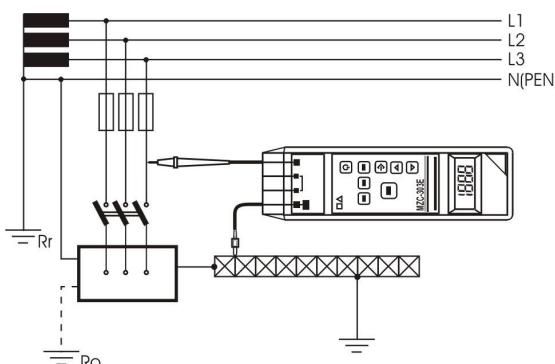
Рис.10. Проверка целостности защитных проводников и уравнительных соединений в сети с защитным зануленiem либо защитным заземлением
