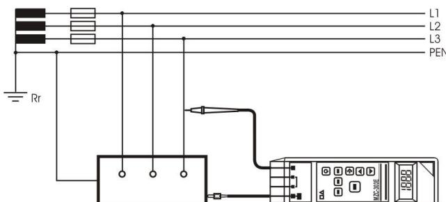
б) сети TT (с защитным заземлением)
