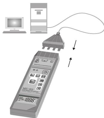
Рис. 12. Соединение кабеля последовательного интерфейса с измерителем
