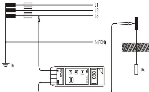
Рис. 9. Способ подключения при измерении сопротивления заземления
