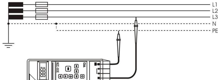
Рис. 7. Измерение в защитной цепи (L-PE)
