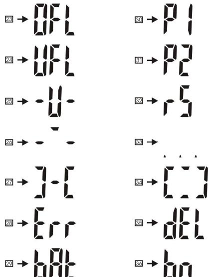
Рис. 4. Надписи и символы, отображаемые на дисплее
